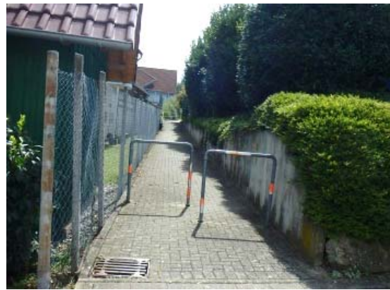
Abb. 4-24: Umlaufsperrern verhindern Nutzung für Räder mit Anhängern
